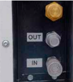
Aansluiting voor brandstoftank
