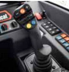
Smart joystick met ingebouwde Bluetooth radio, giekzweeftand en schudden van bak
