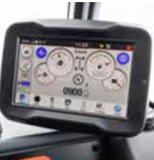
7" touch display met ingebouwde Bluetooth radio, giekzweeftand en microfoon, luidsprekers, telefoonpagina en Job Manager
