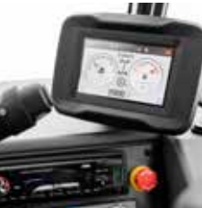
5" display met bluetooth radio, microfoon & luidsprekers
