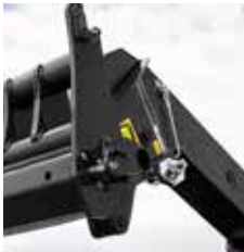
Hydraulische vergrendeling van aanboudwelen met een speciale hulpleiding
