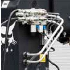
Hydraulische vergrendeling aanbouwdeel
