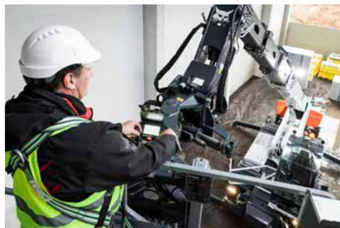
Uitschuifbaar draaiend platform uitgerust met een kabellier
