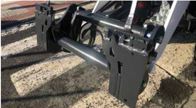
Quick-Tach™ naar Bob-Tach™ adapter (vereist voor alle aanbouwdelen behalve bakken en palletvorken)
