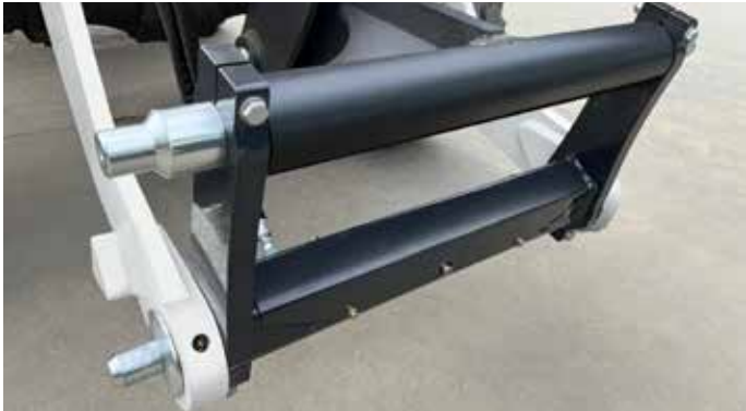
Quick-Tach™ koppeling (standaard geïnstalleerd)
